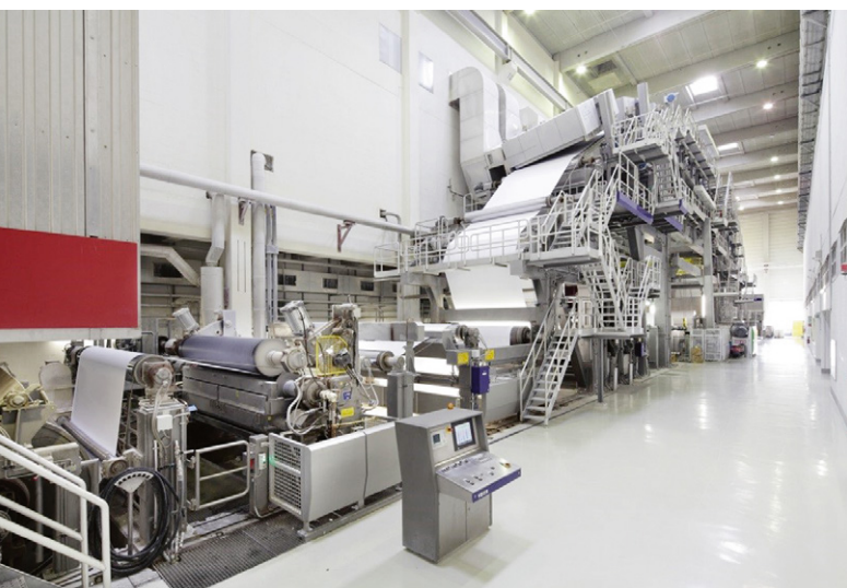
ABBILDUNG 1 Eine Beschichtungsmaschine mit Zustandsüberwachung
